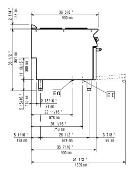
Electrical inlet (power) EQ Equipotential screw
